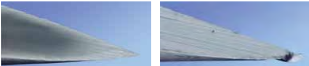
Рис. 12. Игла под увеличением 370 раз до и после инъекции.
